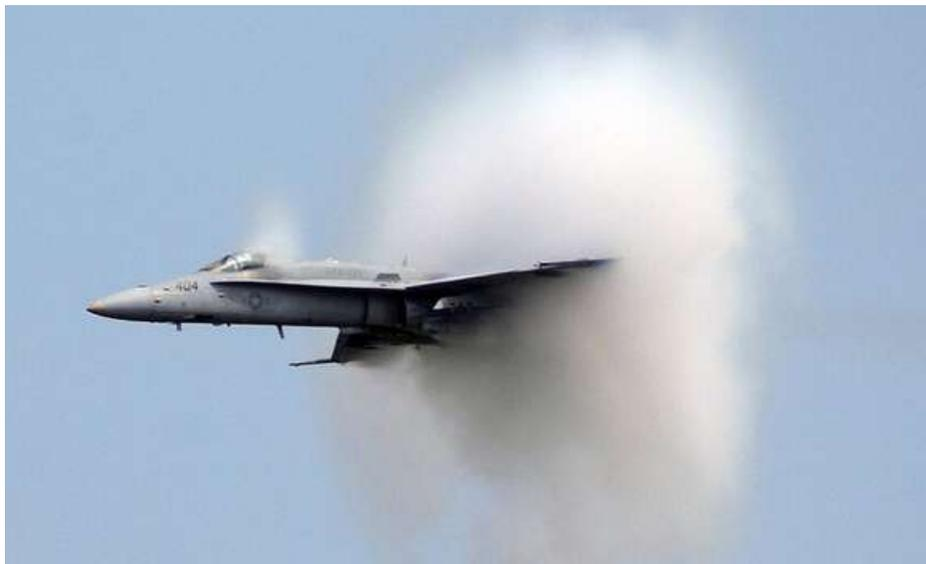
Uno de los desafíos más grandes en la aviación fue superar la "barrera del sonido". A medida que la velocidad de la aeronave se acerca a la velocidad del sonido, la resistencia aumenta drásticamente debido a los efectos de compresibilidad y las ondas de choque.
