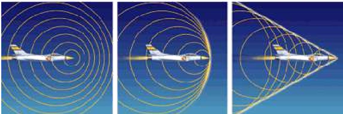
La Mecánica de Fluidos Computacional (CFD) es esencial para estudiar y predecir los efectos de compresibilidad a altas velocidades. Las simulaciones CFD permiten a los ingenieros visualizar y analizar cómo el flujo de aire se comporta en condiciones transónicas y supersónicas.
